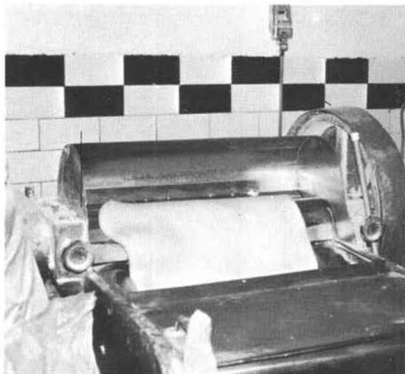
Foto 3. Bregado de un plastón de masa de pan candeal en un cilindro refinador.
